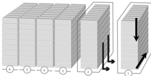
no desenho abaixo. No caso de o pavimento ser de **cor mesclada**, isso é fundamental para que o seu efeito seja mais eficaz, O assentamento deve ser por aplicação completa de colunas de pavimento conforme ilustra a imagem. Deve também utilizar o pavimento de 3 a 4 paletes em simultâneo;
